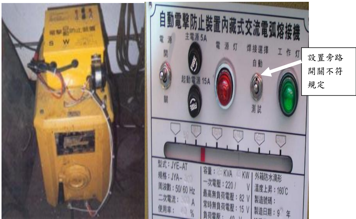
外掛式自動電擊防止裝置 內藏式自動電擊防止裝置 照片 4 交流電焊機自動電擊防止裝置參考例
