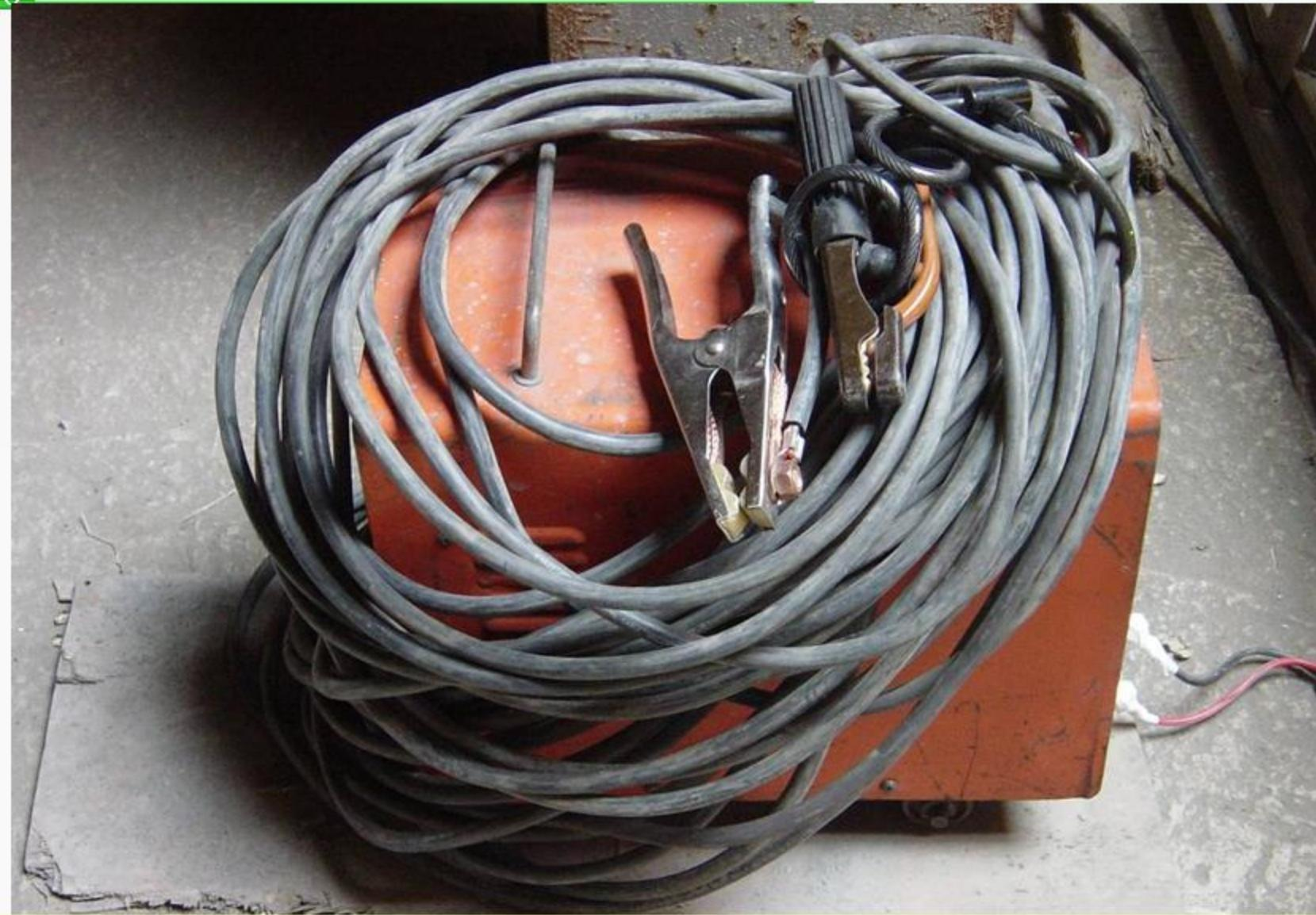
○電焊機使用橡膠電纜，焊把前端之焊夾具絕緣外殼
